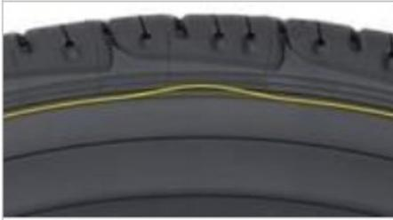
Diagnostic : c'est l'aspect normal du flanc d'un pneu radial.
