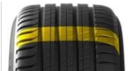
Diagnostic : usure maximale de la bande de roulement
