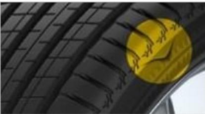
Diagnostic : dommage ne permettant pas une réparation
